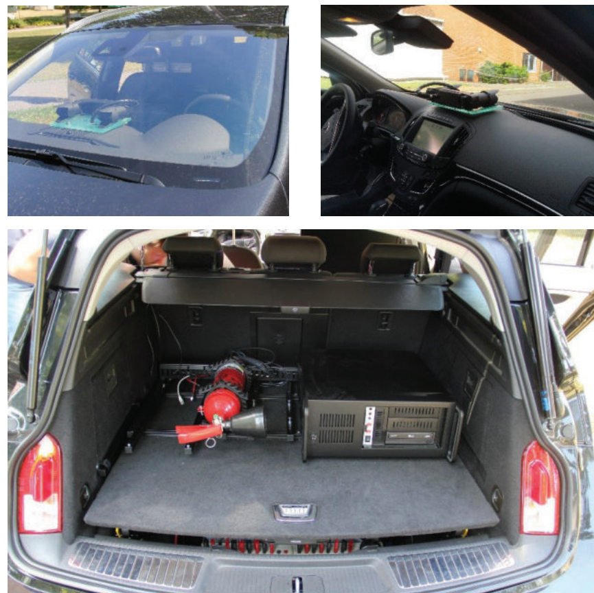
Abb. 11ab: Oben – Stereokamera, Unten: Bildverarbeitungsrechner
