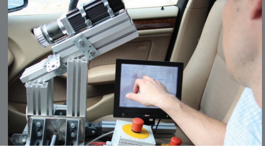
Innenansicht des Forschungsfahrzeuges mit eigens entwickelter Lenkaktorik
