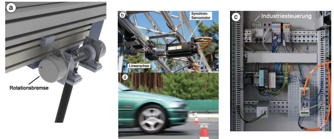
Abb. 17: Schwenkvorrichtung mit integrierter Rotationsbremse (a), Linearachse mit Synchron-Servomotor (b), Schaltschrank mit Industriesteuerung (c) und zur Synchronisation eingesetzte Lichtschranke (d)
