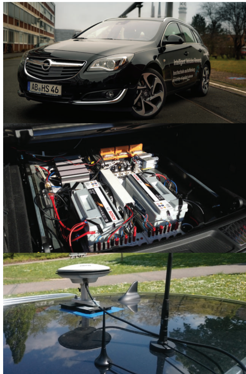
Abb. 23: Neu aufgebauter Versuchsträger Abb. 24: Verstärktes Bordnetz des neuen Versuchsträgers Abb. 25: GNSS-, GSM- und WLAN-Antenne
